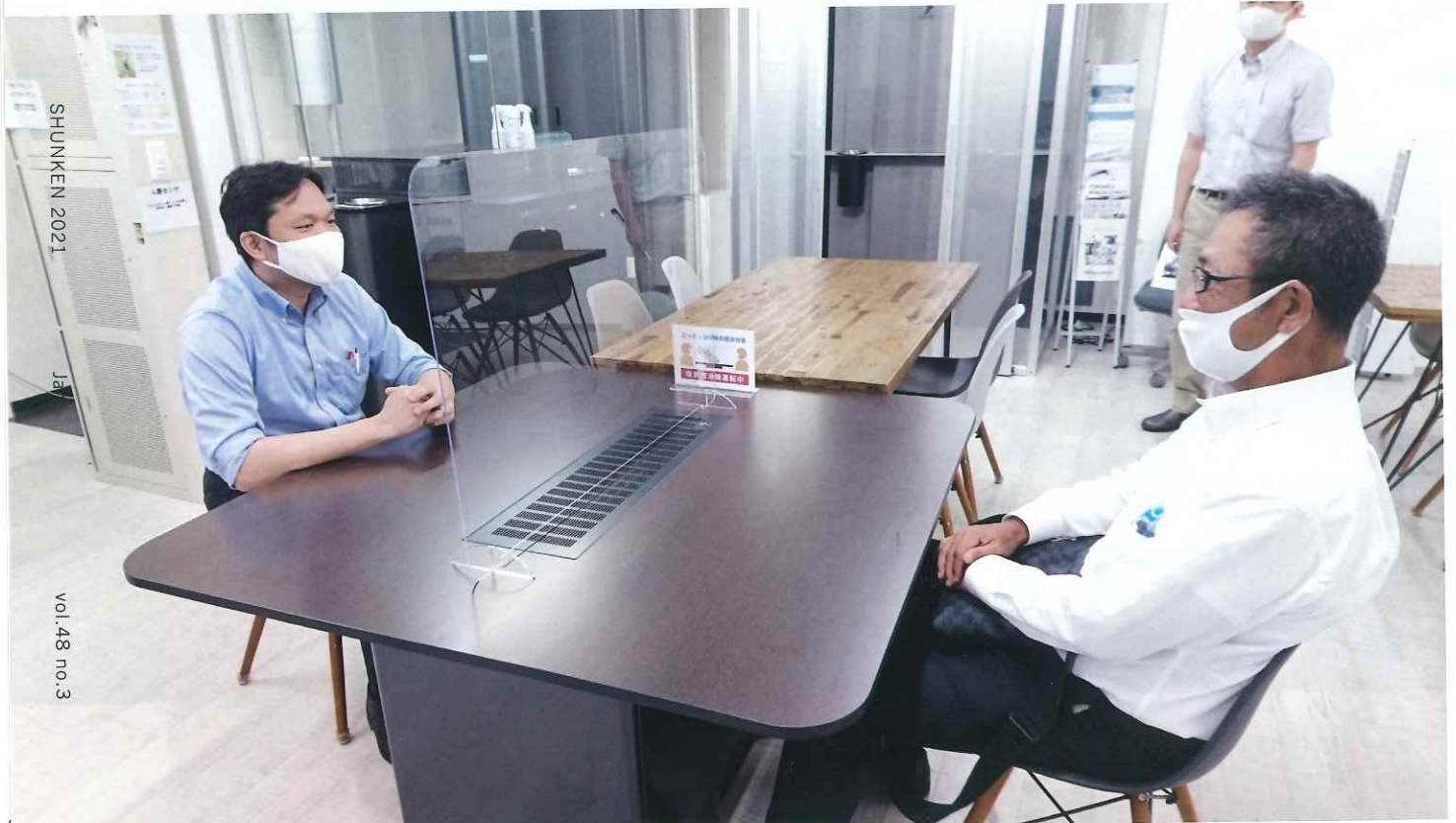
アクリルの衝立によって飛沫の飛散を防ぎ、テーブル上の吸込口で空気を吸引して集塵する装置。
